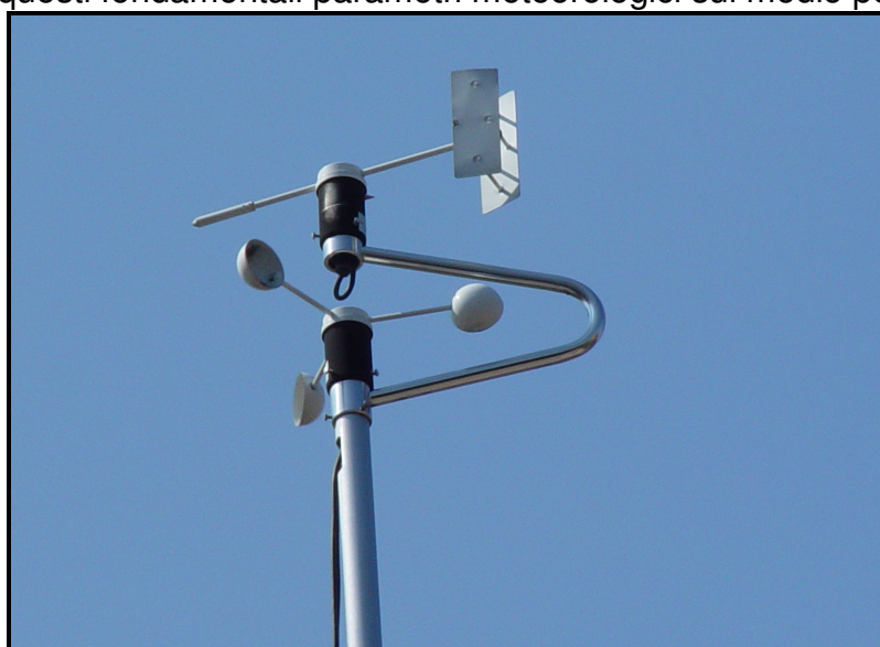
Figura 6 - Anemometro installato presso una delle stazioni di monitoraggio della rete di qualità dell'aria di Verona
